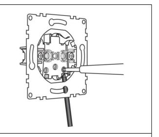
9. Вставить механизм розетки с присоединёнными проводами в монтажную коробку аккуратно, чтобы не повредить провода и не нарушить надёжность их присоединения. Избегать перегибов и замятия проводов. Провода должны лежать в коробке свободно. При необходимости, удалить крепёжные лапки.
